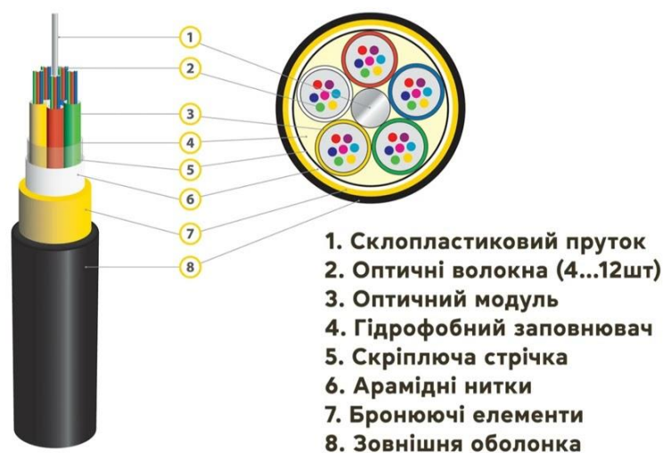
Рисунок 1.9 – Структура оптичного кабелю
