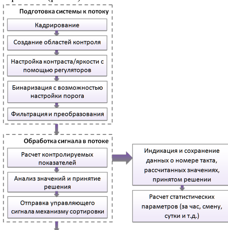
Рисунок 2 – Алгоритм работы системы видеоконтроля
