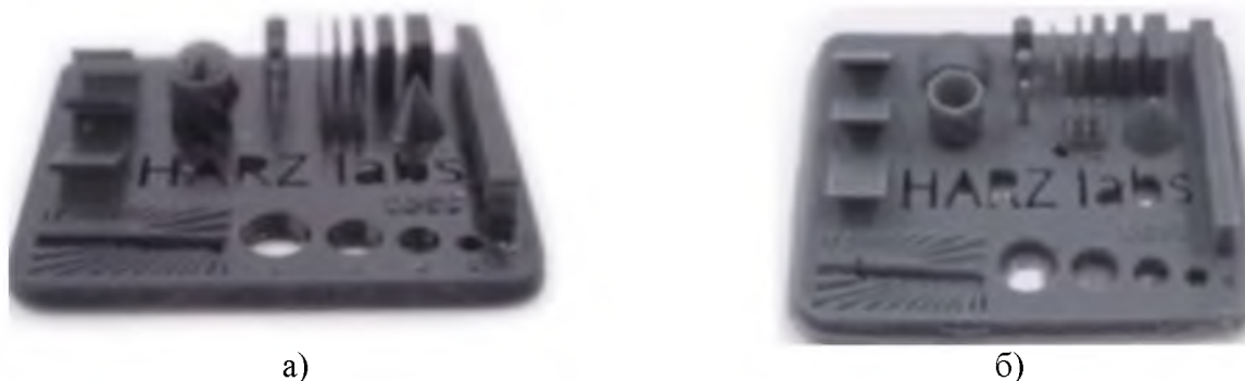
Рисунок 1 – Результати друку фото полімерними смолами (а) модель отримання фотополімерною смолою PlexiWire (б) модель отримання фотополімерною смолою Monofilament Basic
