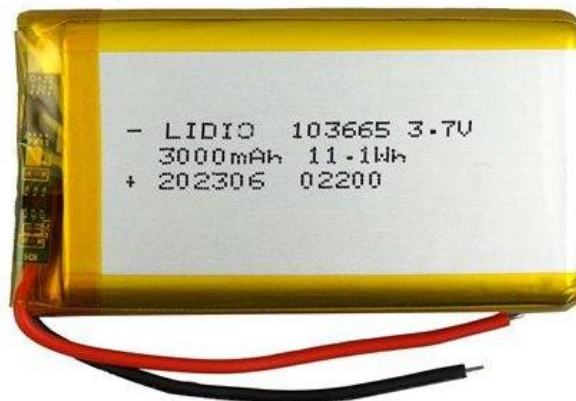
Рисунок 2.7 – Акумулятор літєво-полімерний Li-Po 3000 мА/год 3,7 В
