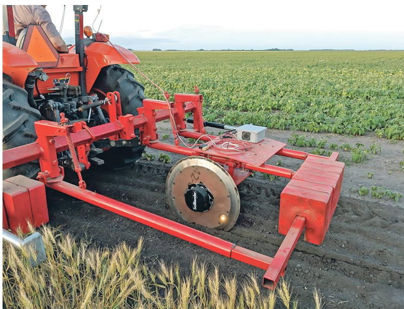
Рисунок 1.12 – SoilReader, розміщений на сільськогосподарській техніці
