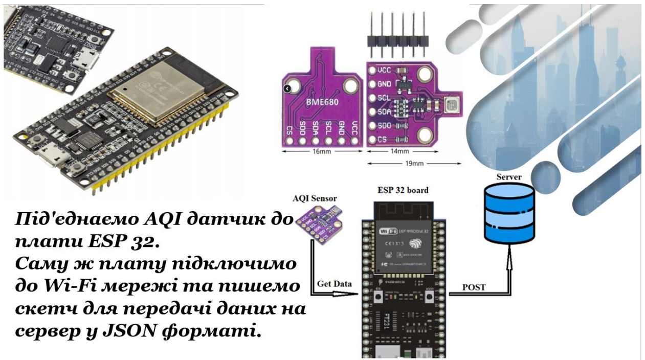
Рисунок В.12 – Підключення схеми та передача даних на сервер
