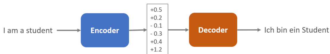
Рисунок 2.1 – Нейронна архітектура «кодер-декодер»
