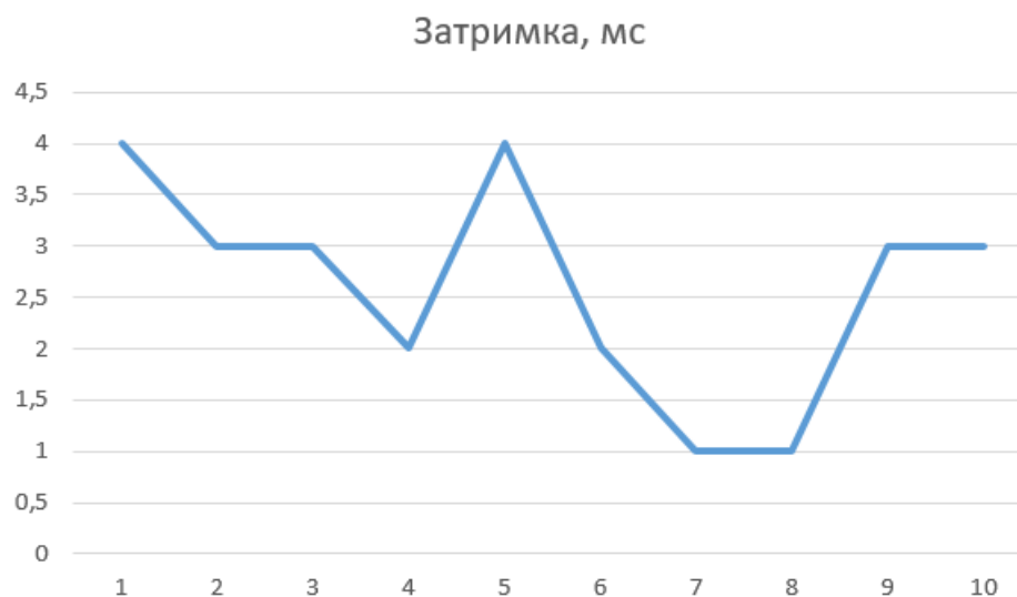
Рисунок 2.9 – Графік затримки передавання MQTT-повідомлень під час тестування
