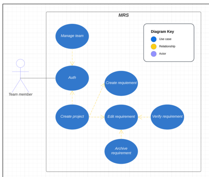
Рисунок 3.1 – Діаграма Use Case для проекту спланованого ітеративно (Рисунок виконаний самостійно)
