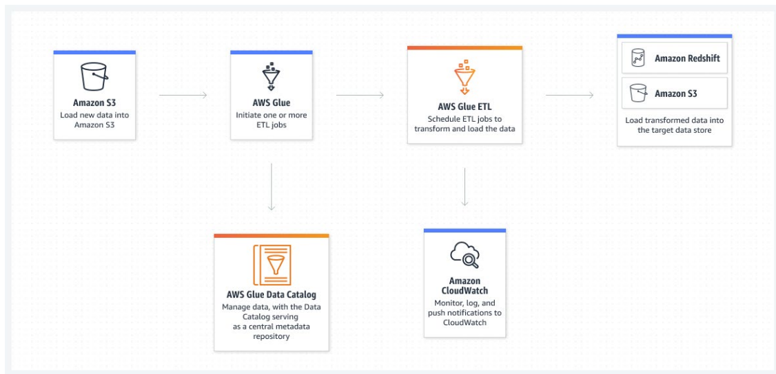
Рисунок 2.10 – Схема архітектури сервісів AWS
