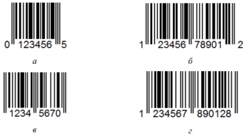
Рисунок 3.7 – Товарні коди EAN/UPC: а – UPC-E; б – UPC-A; в – EAN-8; г – EAN-13
