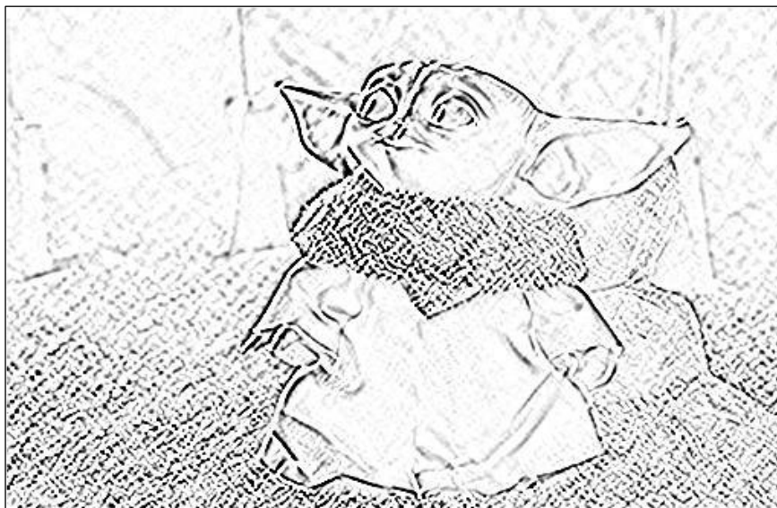
Рисунок 4.1 – Виділення контурів за допомогою фільтра Собеля з ядром 5x5
