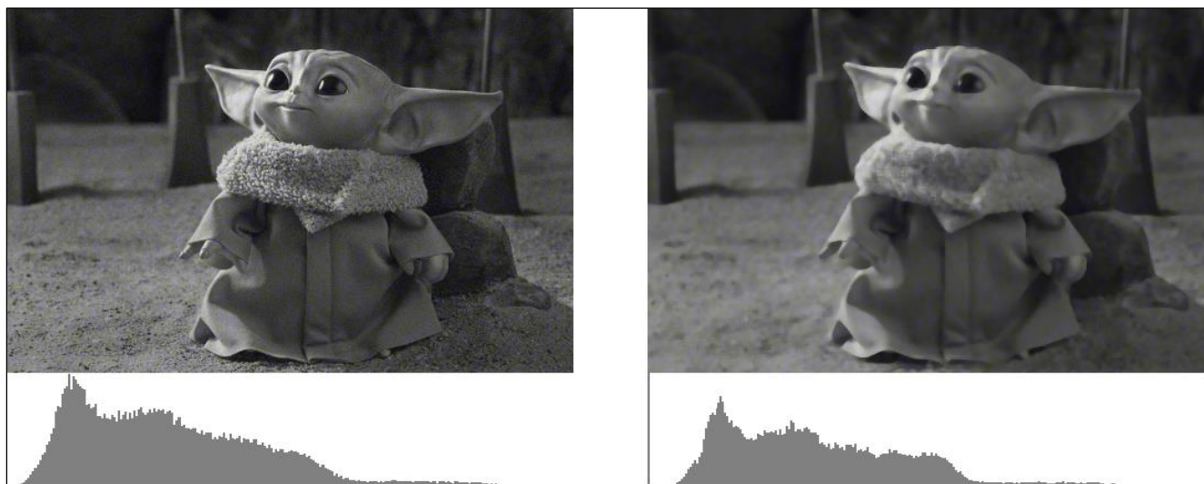
Рисунок 2.3 – Зображення з рівномірним шумом до фільтрації фільтром середнього значення та після
