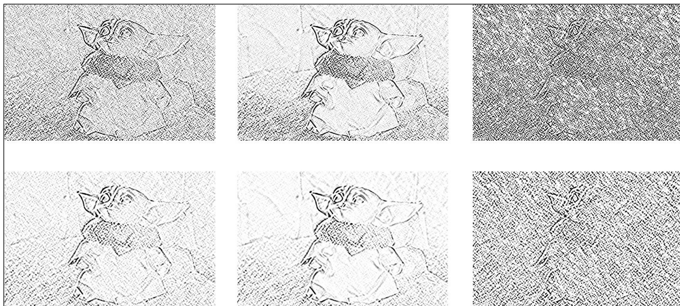
Рисунок 4.3 – Порівняння роботи фільтра Собеля на зашумлених зображення, та тих же зображеннях після фільтрації фільтром Гауса.
