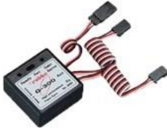
Рисунок 1.1 – Приклад реалізації гіроскопа для мобільного робота
