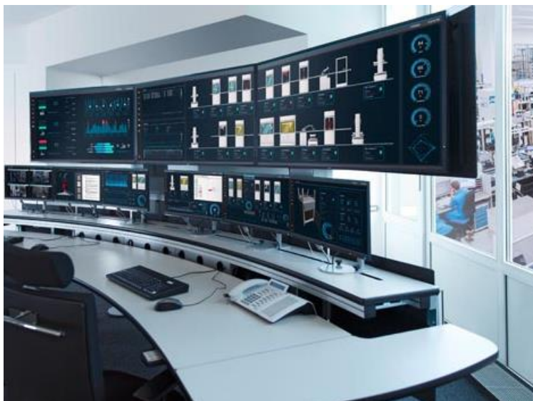
Рисунок 1.4 – Приклад інтерфейсу SCADA-системи Siemens WinCC [11]
