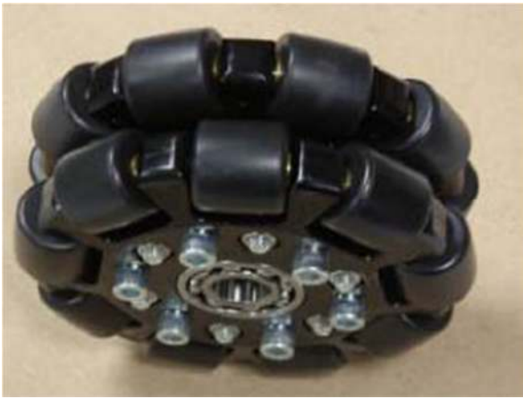
Рисунок 2.6 – Шведські колеса з роликами, повернені на 90 та 45 градусів
