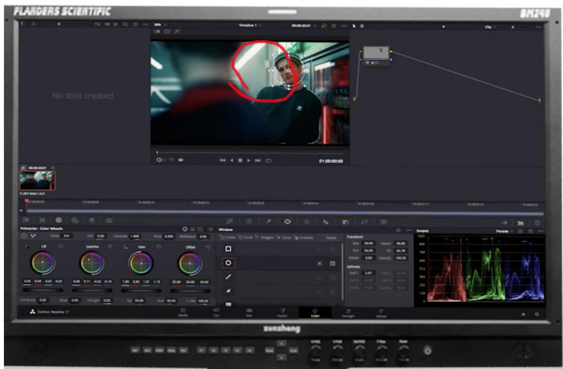
Рисунок 3.24 – На екрані з зображенням ми бачимо виділений червоним приклад маски, для впливу обробки на виділену область
