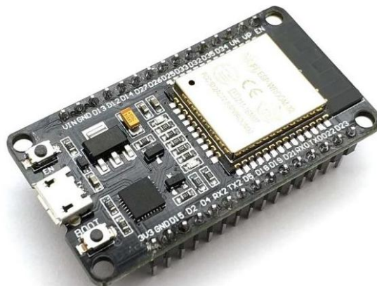
Рисунок 2.1 – Загальний вигляд ESP32 DevKit V1 [47]
