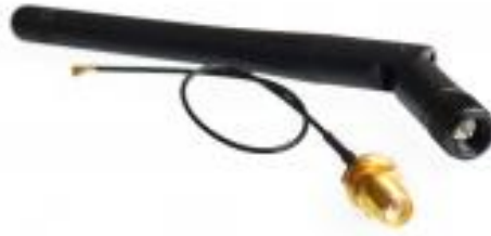
Рисунок 2.11 – Зовнішня антена Wi-Fi 2.4 ГГц 3 dBi [66]
