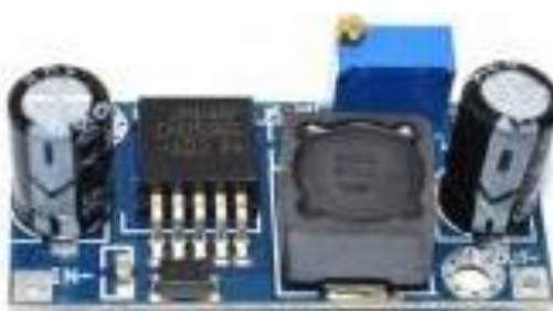
Рисунок 2.9 – Загальний вигляд DC-DC понижуючого конвертера на базі мікросхеми LM2596 [64]
