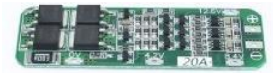
Рисунок 2.8 – Загальний вигляд BMS плати [63]
