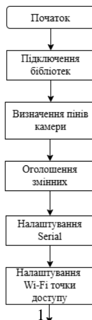
Рисунок 3.1 – Алгоритм роботи програми ESP32-CAM (частина 1)
