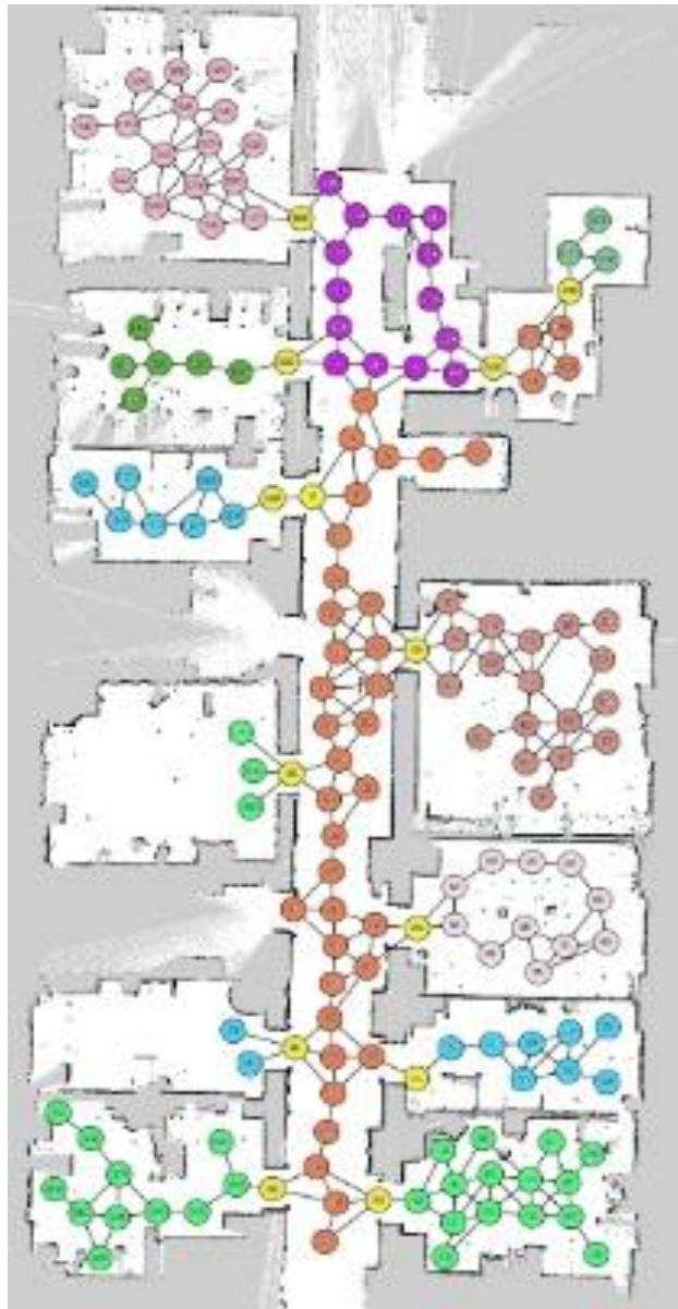
Рисунок 1.8 – Алгоритм Topological SLAM
