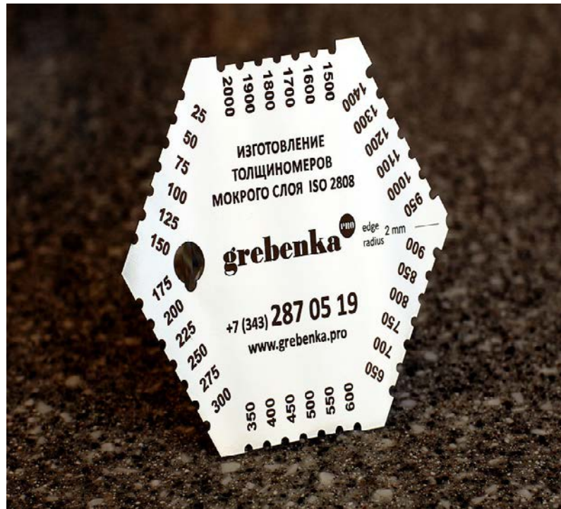
Рисунок 1.1 – Механічний товщиномір «Гребінка»
