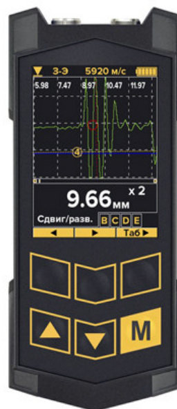
Рисунок 1.4 – Товщиномір ультразвуковий Константа Булат 3
