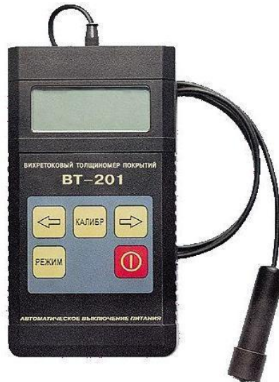
Рисунок 1.3 – Товщиномір вихрострумівий BT-201
