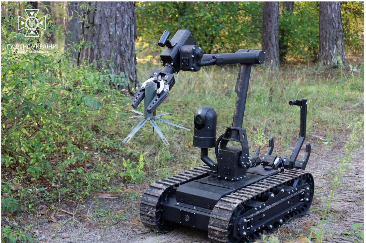
Рисунок 1.8 – Застосування РК з системою дистанційного керування
