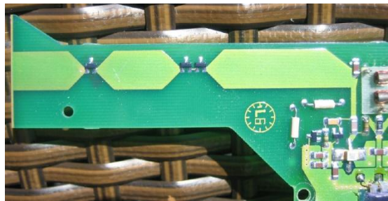
Рисунок 3 – Зовнішній вигляд плеча диполя з реконфігурацією ADD153
