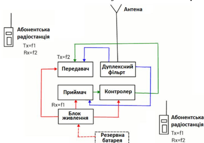
Рисунок 1 – Типова структурна схема репітера
