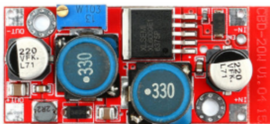
Рисунок 5.12 - DC-DC підвищує / понижуючий перетворювач, XL6009
