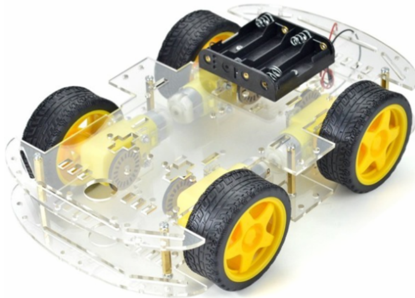
Рисунок 5.3 – Зібрана модель мобільної платформи 4WD від фірми Elecrow
