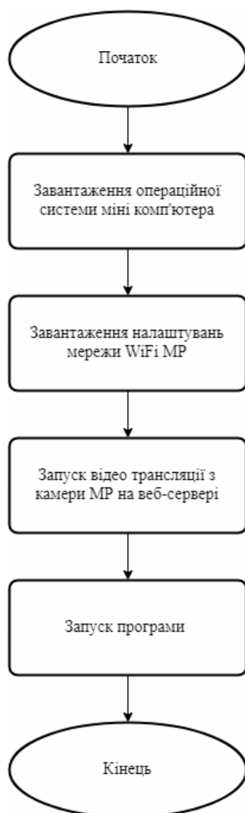
Рисунок 7.6 – Схема алгоритму завантаження процесів для керування
