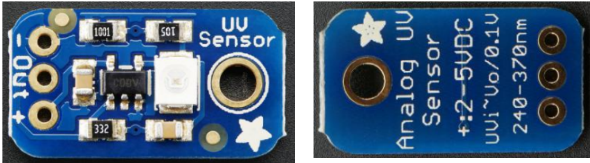
Рисунок 1.37 - Загальний вид аналогового датчика ультрафіолету на GUVA-S12SD
