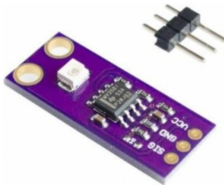
Рисунок 1.46 - Загальний вид датчика ультрафіолету на GUVA-S12SD
