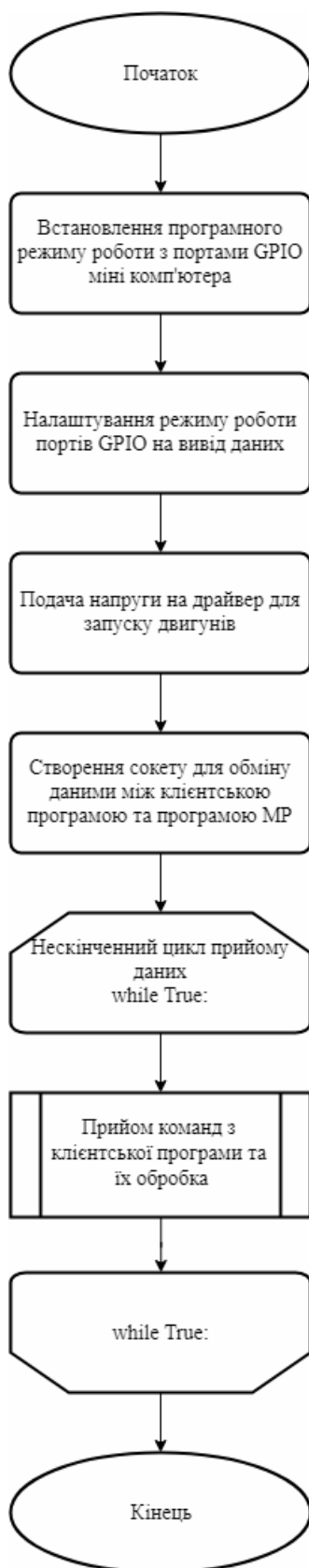
Рисунку 7.7 – Узагальнена схема алгоритму серверної програми керування на MR
