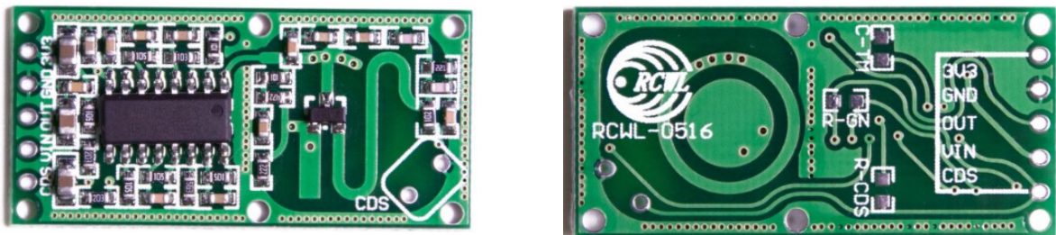
Рисунок 1.40 - Загальний вид датчика руху RCWL-0516
