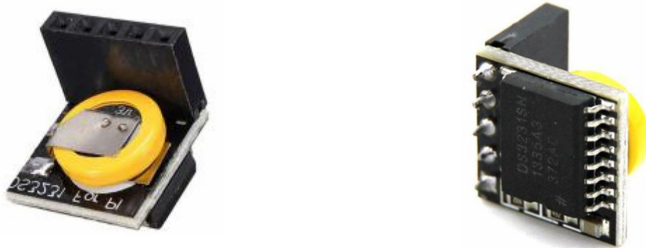
Рисунок 1.33 - Модуль годин реального часу для Raspberry Pi
