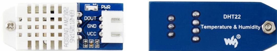
Рисунок 1.52 - Загальний вид датчика температури й вологості DHT22
