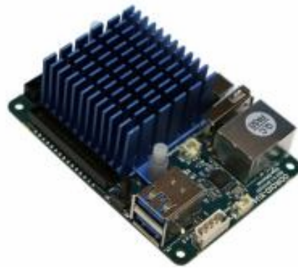
Рисунок 1.12 - Загальний вид ODROID-XU4Q
