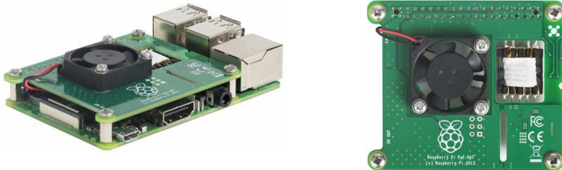
Рисунок 1.21 - Загальний вид модуля PoE живлення POE_BOARD
