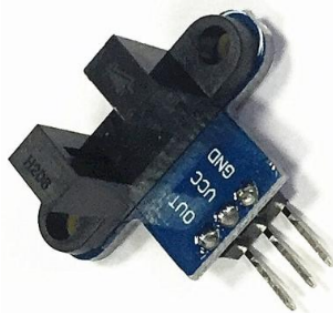
Рисунок 1.57 - Загальний вид оптичного датчика
