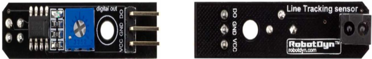
Рисунок 1.41 - Датчик лінії для Arduino від Robotdyn
