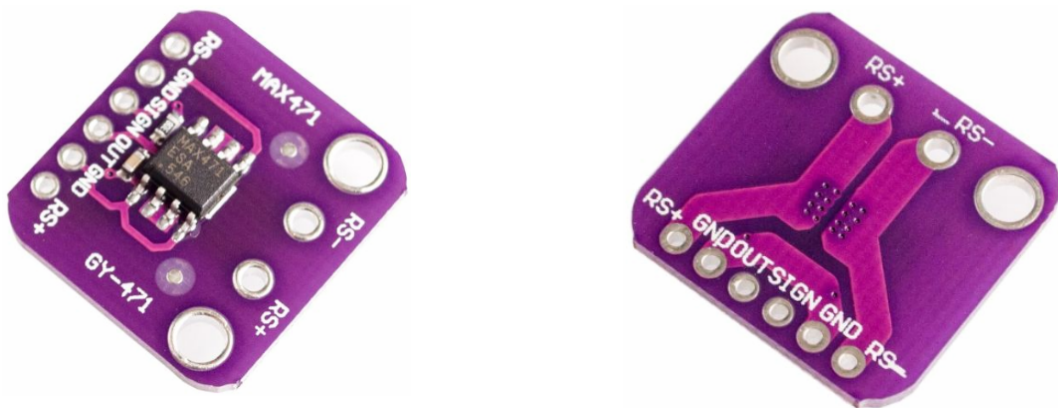
Рисунок 1.45 - Загальний вид датчик струму з аналоговим виходом на MAX471
