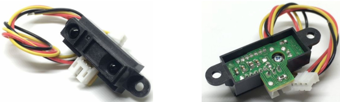
Рисунок 1.35 - IR датчик відстані Sharp Sharp GP2Y0A21YK0F
