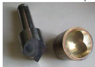
Рис. 11. Технологическая оправка и зеркало в виде трехгранного 90° отражателя
