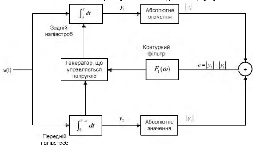
Рис. 1. Схема замкнутого тактового (символьного) синхронізатора
