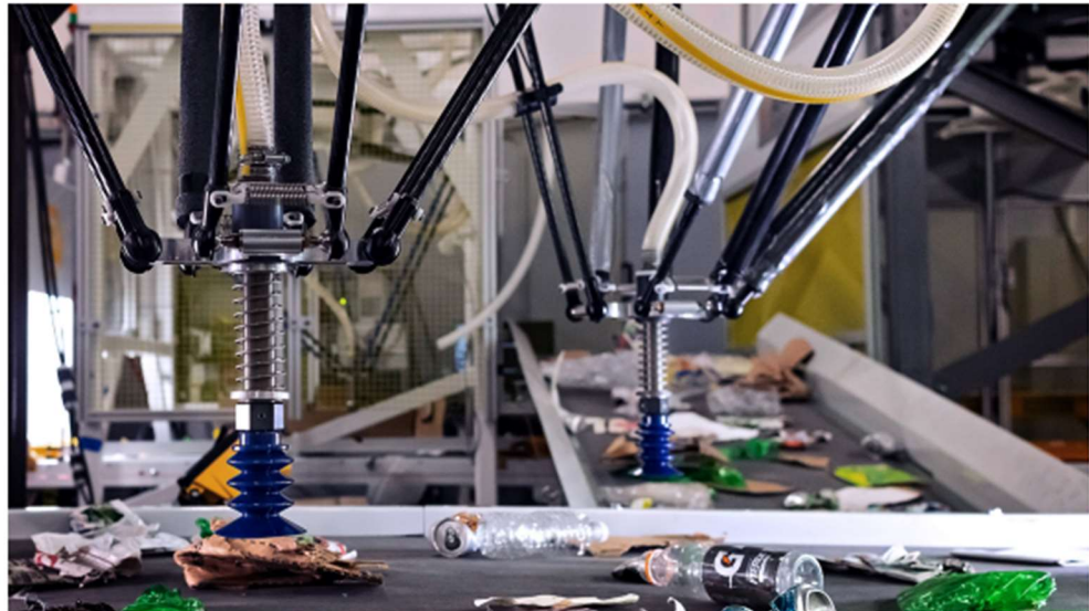
Рисунок 1.4 – Приклад паралельного робота маніпулятора
