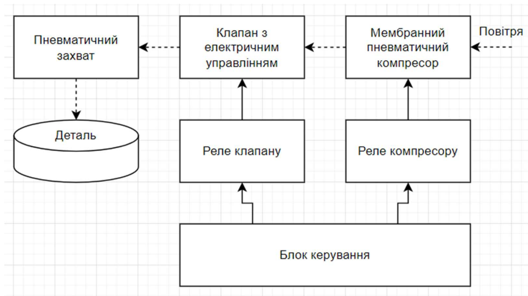
Рисунок 3.5 – Структурна схема підсистеми пневматичного захвату деталей
