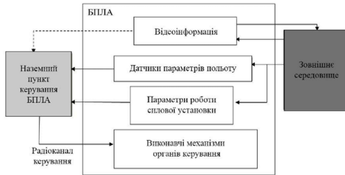
Рисунок 2.1 – Структура пілотажного методу керування БПЛА
