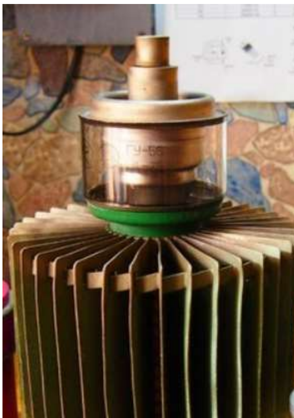
Рисунок 1.1 – Ранні системи охолодження електронних ламп (перша половина ХХ ст.)
