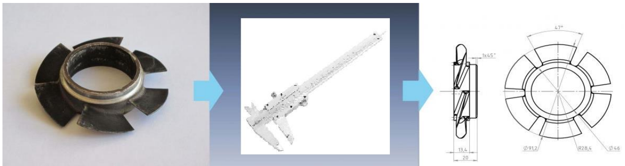
Рисунок 1.1 – Інструментальний метод реверс-інженерінгу [5]
