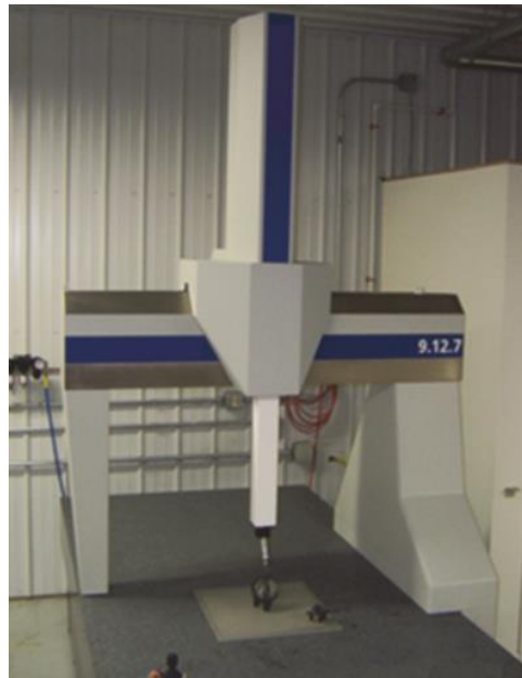
Рисунок 1.4 – Координатно-вимірні машина з двома фіксованими взаємно перпендикулярними вимірними плечима [7]
