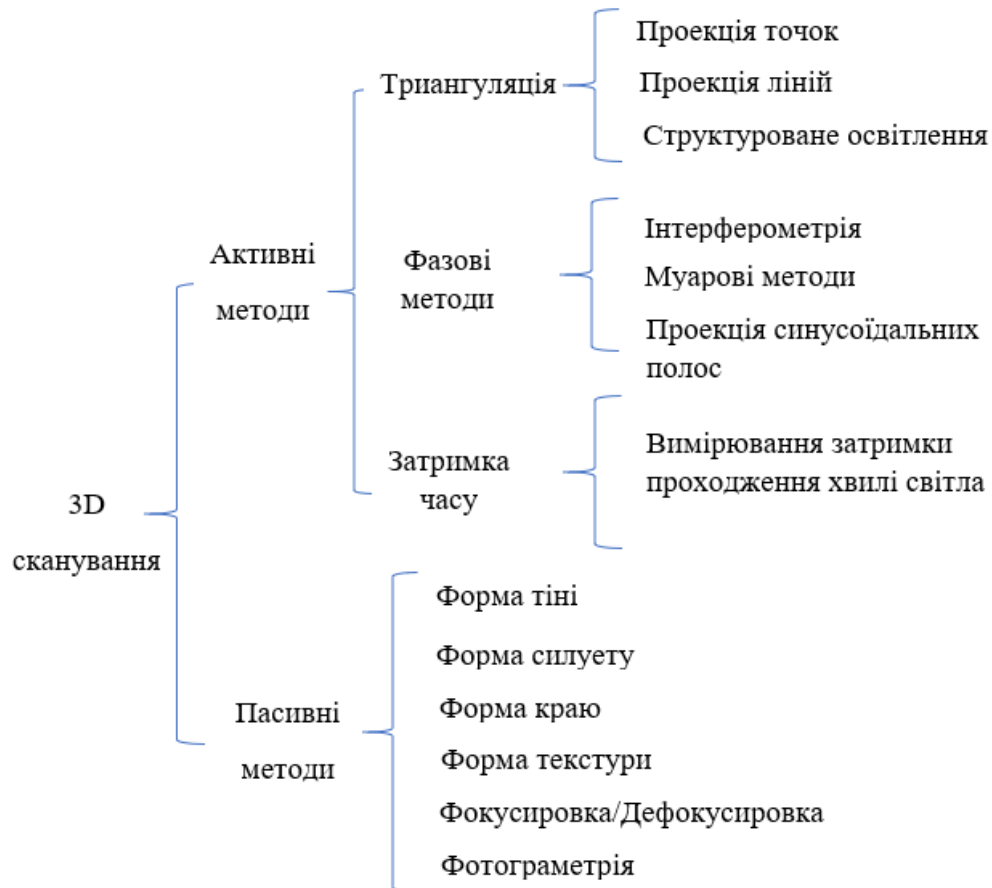
Рисунок 1.3 – Безконтактні методи 3D-сканування
