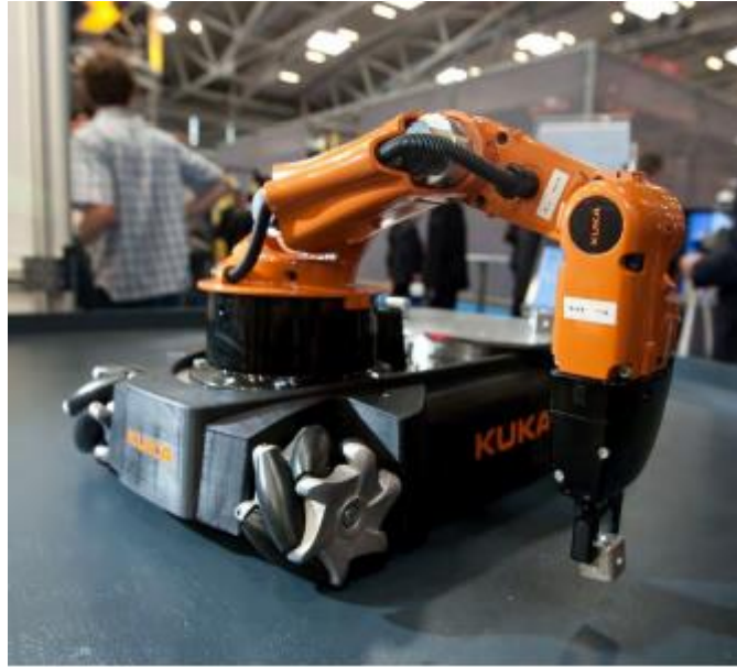
Рисунок 1.8 – Оснащений захватом маніпулятор з шістьма ступенями свободи на мобільній платформі KUKAyouBot
