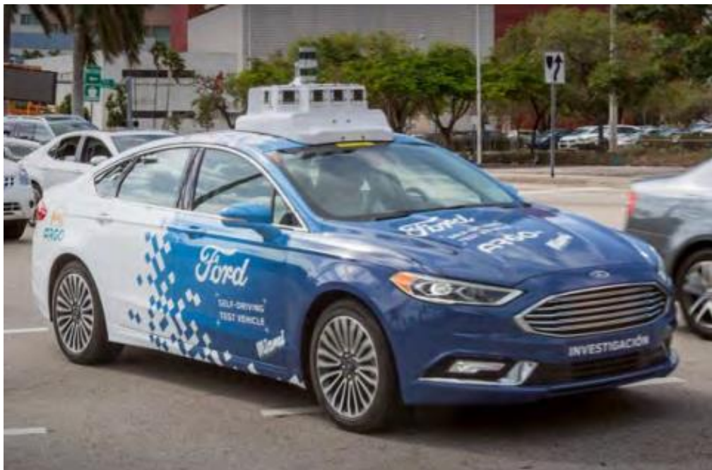
Рисунок 1.6 – Камери у складі системи інформаційного забезпечення на безпілотному автомобілі Ford
