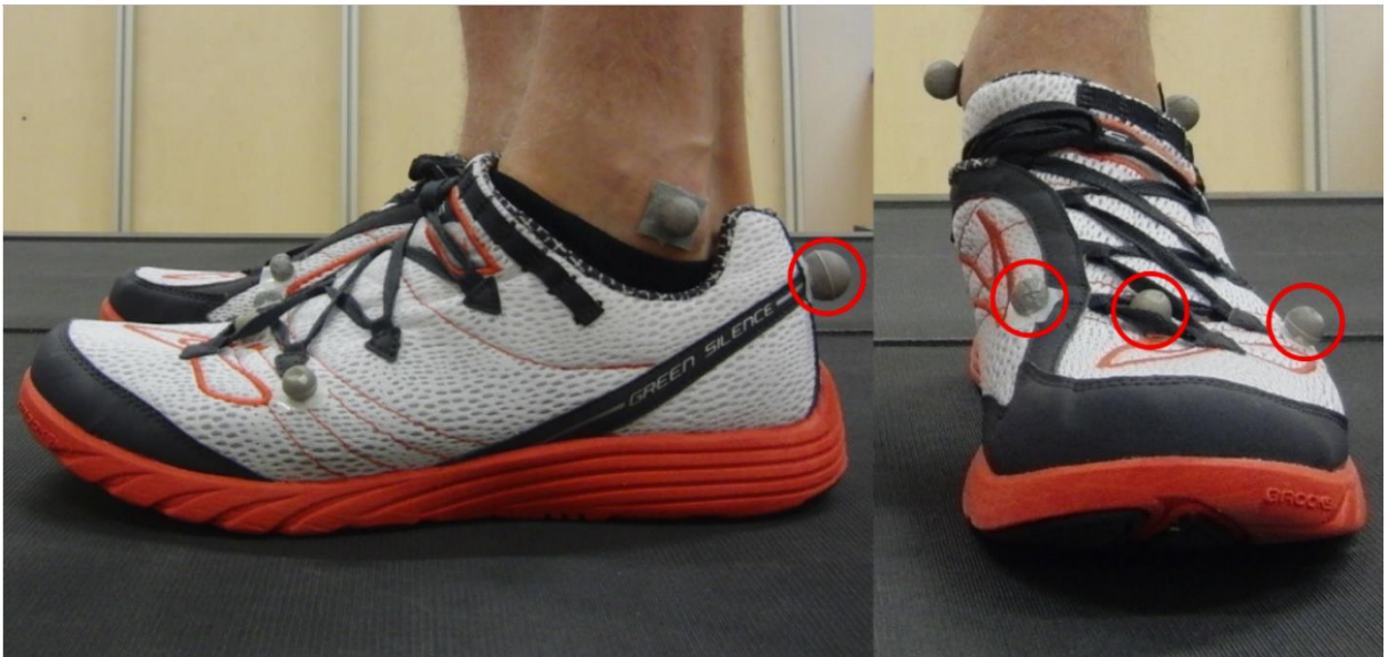
Рисунок 2.1 – Місця встановлення маркерів для запису рухів стопи
