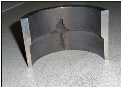
Рис. 3 – Фрагмент трубопровода с кавитационной каверной (дефектом)
