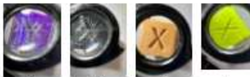
а) – зразок PLA пластику; б) – зразок PETG пластику; в) – зразок ABS пластику; г) – зразок Nylon пластику Рис.7. Результати тестових зразків на абсорбцію та гідратацію вологи
