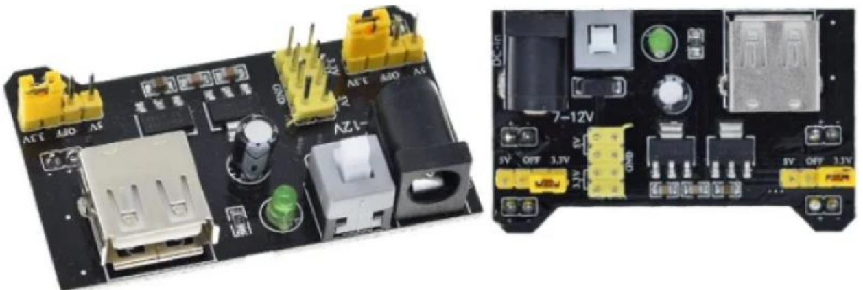
Рисунок 3.4 – Макетний модуль живлення типу MB-102 [13]
