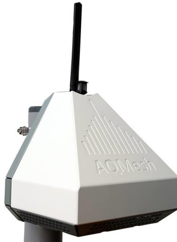
Рисунок 1.6 – AQMesh система моніторингу якості повітря [7]
