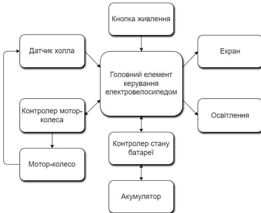
Рисунок 2.9 – Структурна схема реалізації електровелосипеда на одному програмованому контролері.
