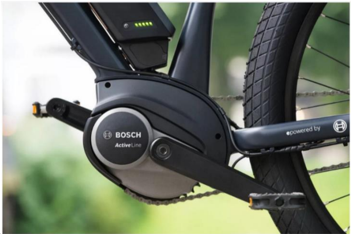
Рисунок 2.13 – Приклад системи кареткового двигуна (також відомий як центральний мотор, "підвісний" мотор).
