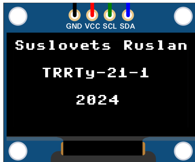
Рисунок 3.10 – Відображення тексту на OLED дисплею після проходження ініціалізації дисплею
