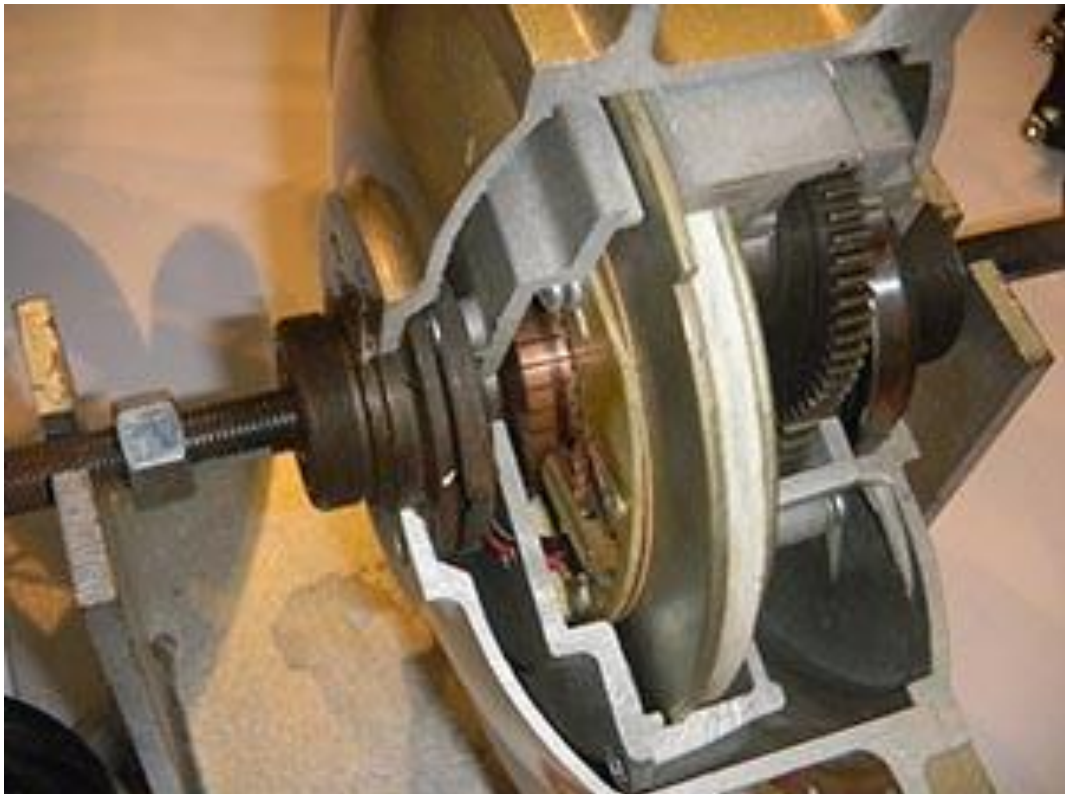
Рисунок 2.14 – Колекторний електродвигун з щіточною системою подачі напруги на обмотки.
