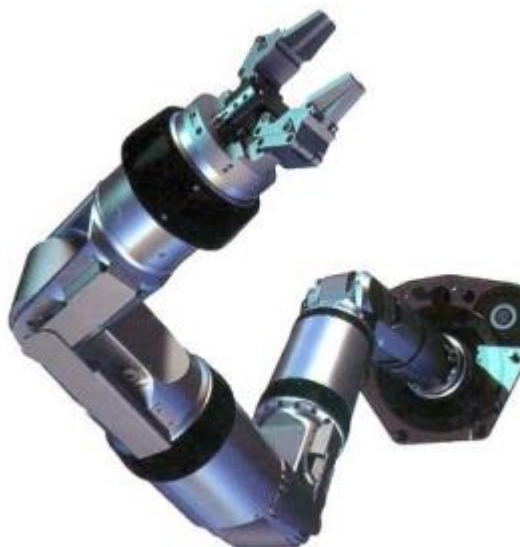
Рисунок 2.10 – Наземний РТК у вигляді ланцюгової конструкції складеної з окремих однотипних елементів
