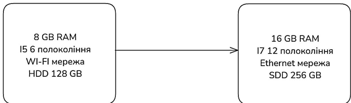
Рисунок 3.9 – Схема вертикального масштабування
