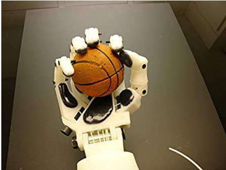
Рисунок 1 – Ілюстрація захвату м'яча протезом
