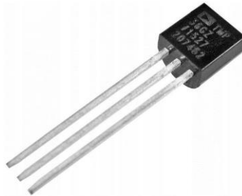
Рисунок 6.25 – Зовнішній вигляд температурного датчика TMP36gz
