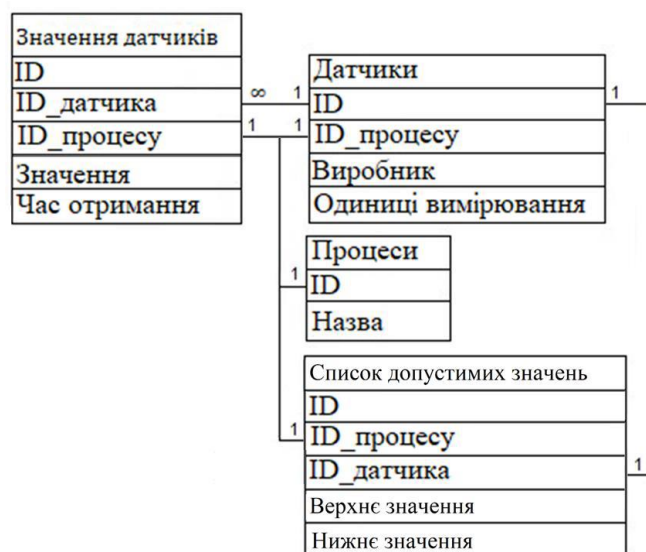
Рисунок 6.35 – Логічна модель бази даних для віддаленого серверу.
