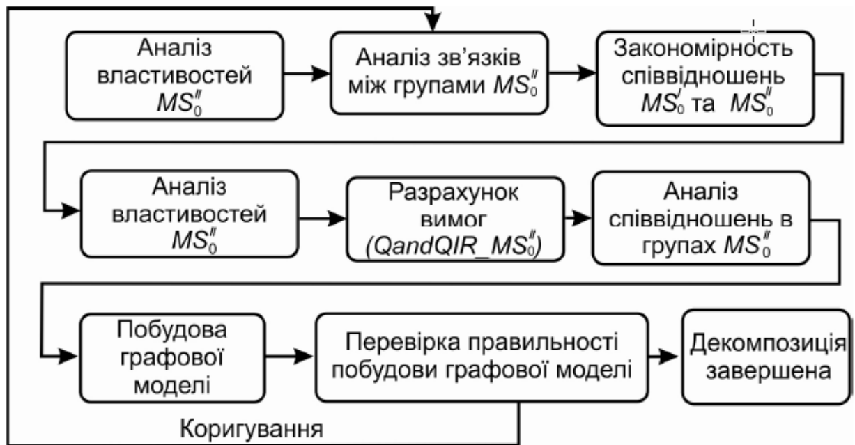
Рисунок 2.2 – Узагальнений алгоритм методу декомпозиції кіберфізичних систем як метасистеми ( MS'_0 )
