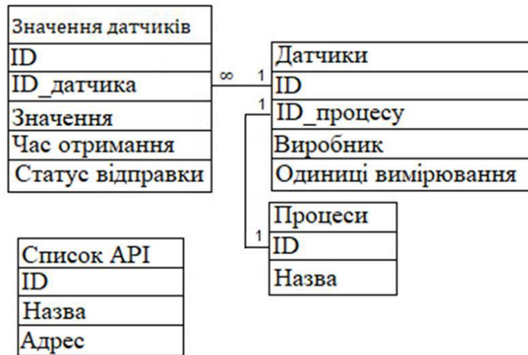
Рисунок 6.34 – Логічна модель бази даних для Raspberry Pi 4.
