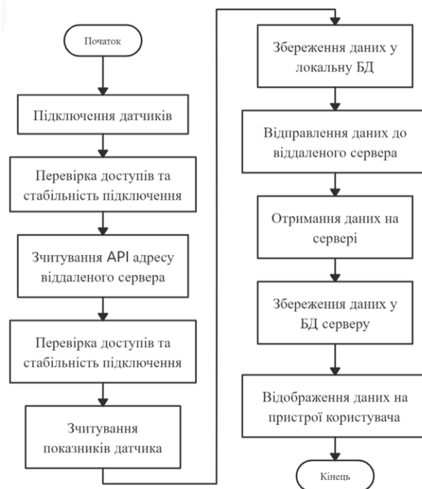
Рисунок 6.27 – Узагальнений алгоритм роботи макету системи моніторингу та візуалізації даних для кіберфізичних виробничих систем
