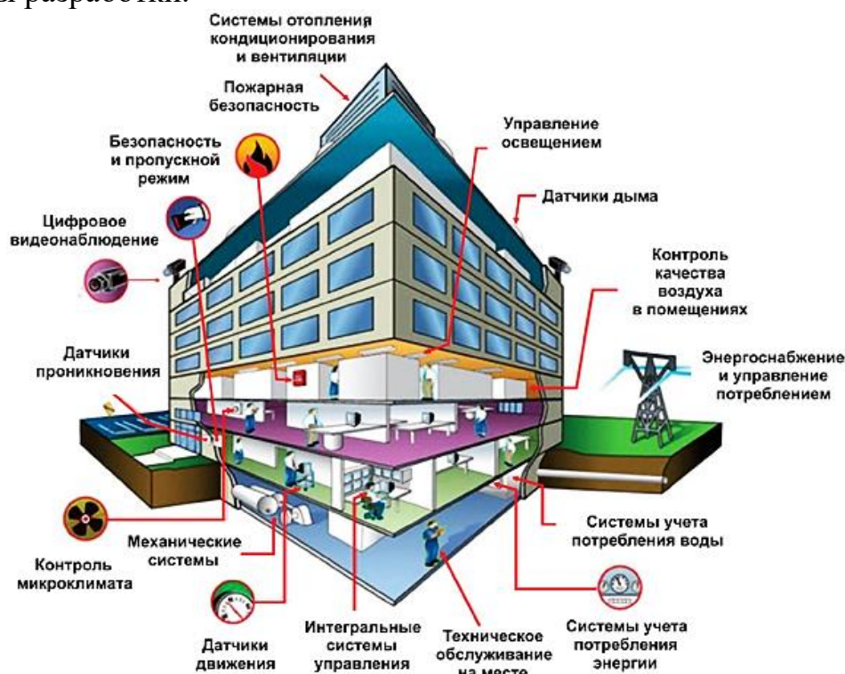
Рисунок 1 — Система автоматизации зданий
