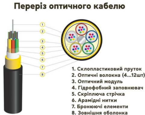
Рисунок 2.7 – Розріз оптичного кабелю
