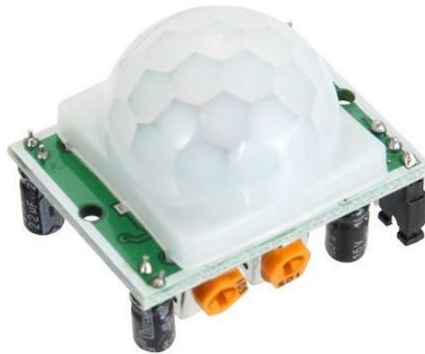
Рисунок 3.1 – Інфрачервоний датчик руху HC-SR501
