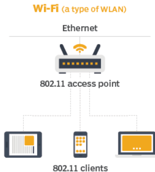
Рисунок 2.1 – Приклад підключення пристроїв через стандарт 802.11
