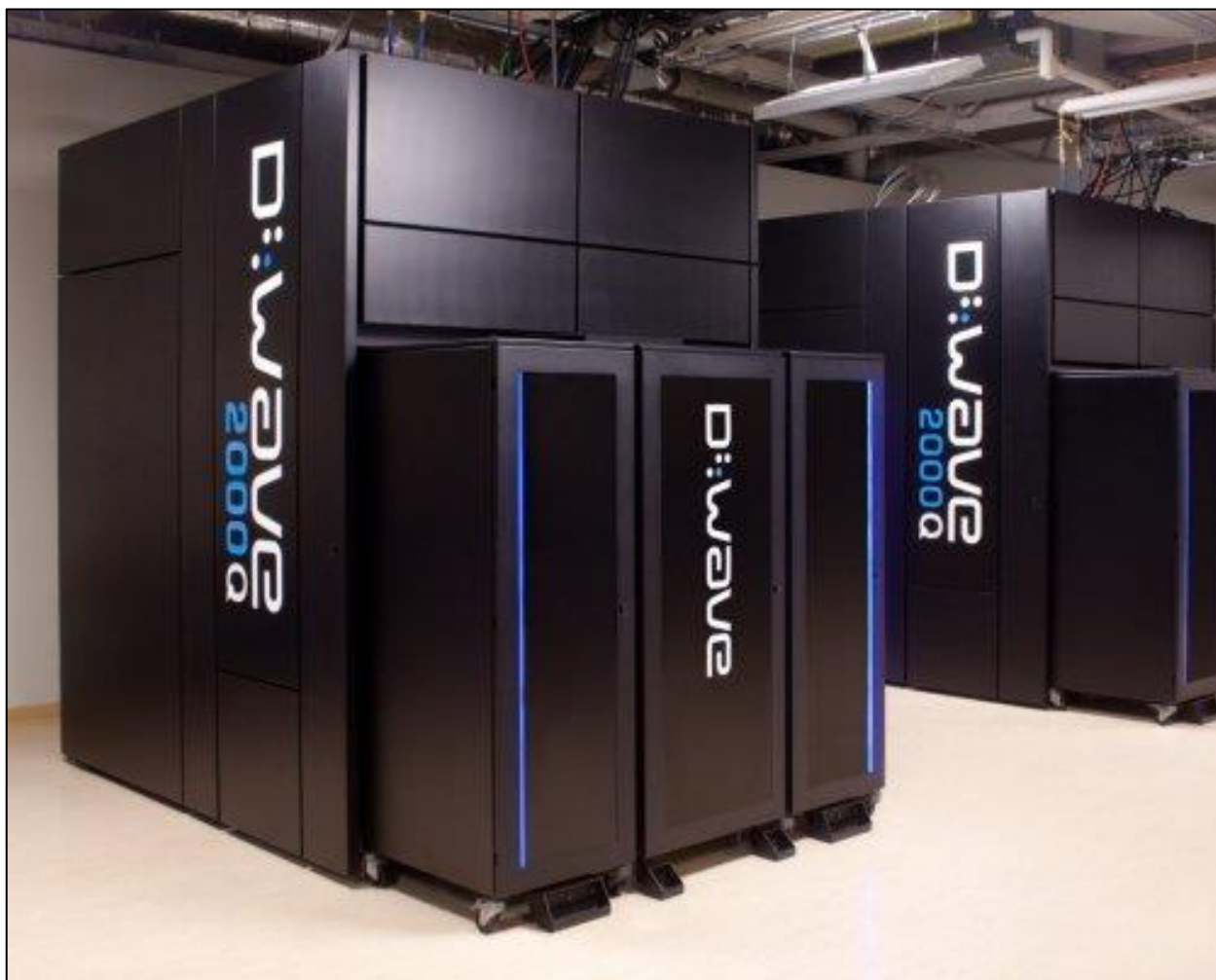
Рисунок 1.4 Квантовий комп'ютер D-Wave D-Wave 2000Q з 2000-кубітним процесором
