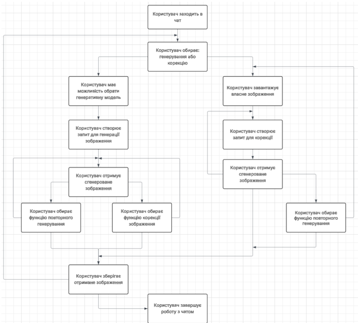
Рисунок А.16 – Карта алгоритму роботи системи створення і корекції зображень в діалозі
