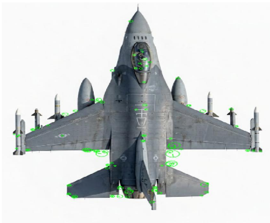
Рисунок 1 – Візуалізація знайдених ключових точок на еталонному зображенні БПЛА
