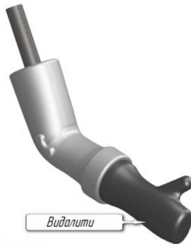
Рисунок 3.50 – Видалення заготовки з «Термосилу»
