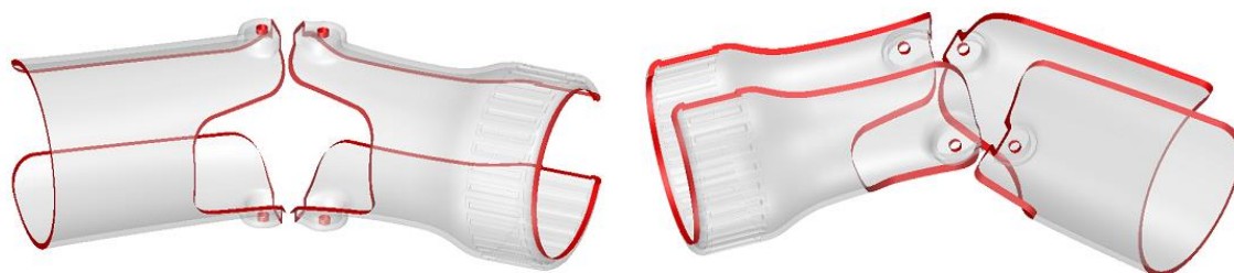
Рисунок 3.51 – Приклад розрізу заготовки для отримання гільз плеча й передпліччя
