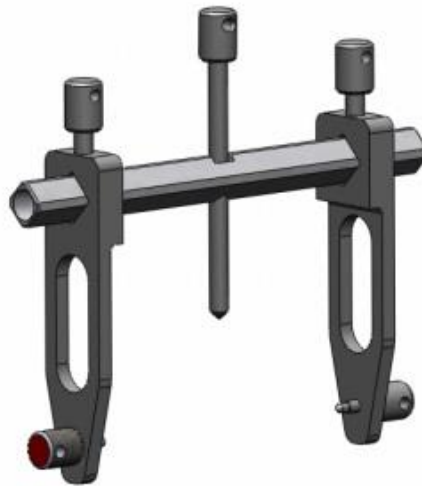
Рисунок 3.45 – Пристосування для паралельного співвісного встановлення шарнірів шин
