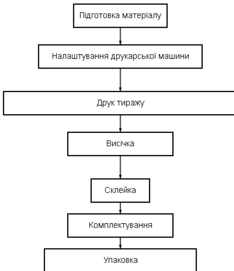
Рисунок 4.2 - Схема технологічного друкарського та післядрукарського процесів
