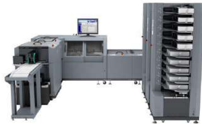
Рисунок 5.5 – ВШПА DUPLO DBMI Saddle System
