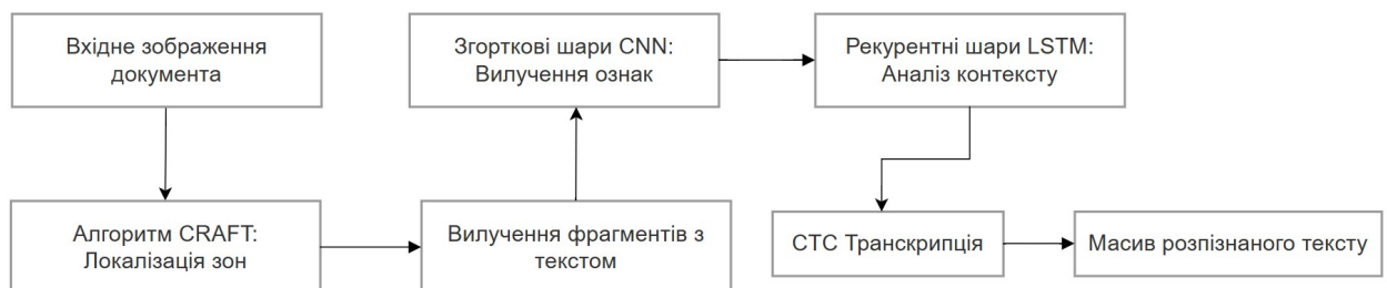
Рисунок 2.1 – Загальна схема алгоритму локалізації та розпізнавання тексту
