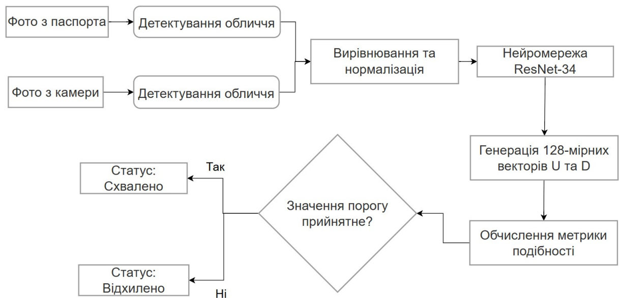
Рисунок 2.2 – Схема алгоритму біометричної верифікації обличчя
