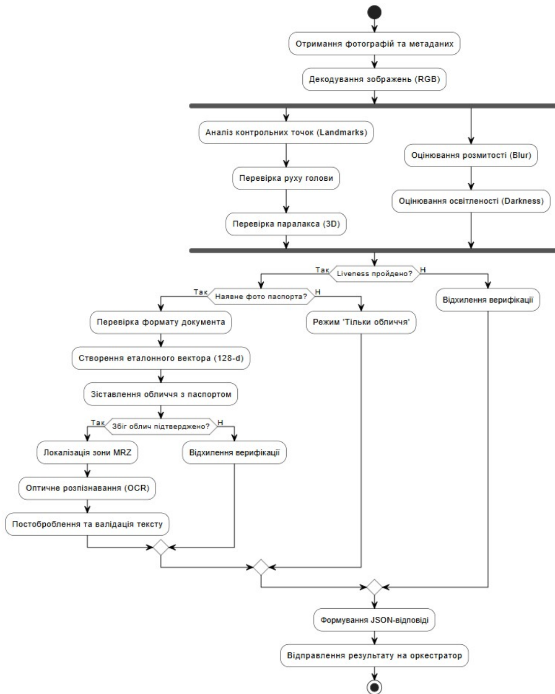
Рисунок 3.5 – Діаграма діяльності процесу неймережевого аналізу зображень
