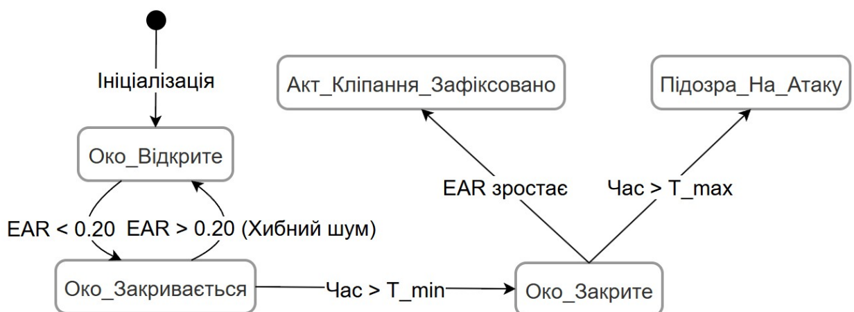
Рисунок 2.3 – Схема переходів станів детектора очей на основі метрики EAR
