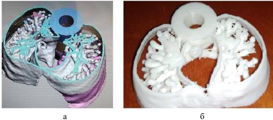
Рисунок 1. Иллюстрация прототипирования одиночного среза натурной модели легких: а) компьютерная модель; б) напечатанная натурная модель
