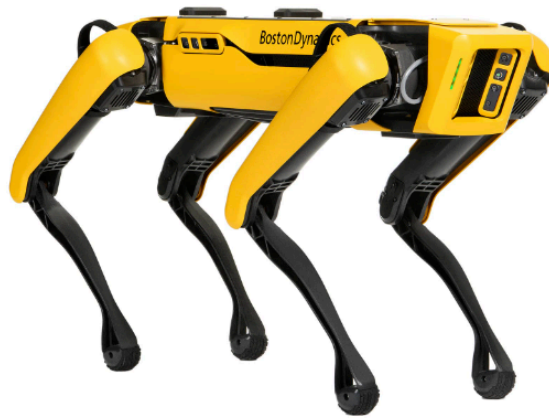
Рисунок 2.3 – НРЗ на базі крокуючого шасі « Spot » by Boston Dynamics [27]
