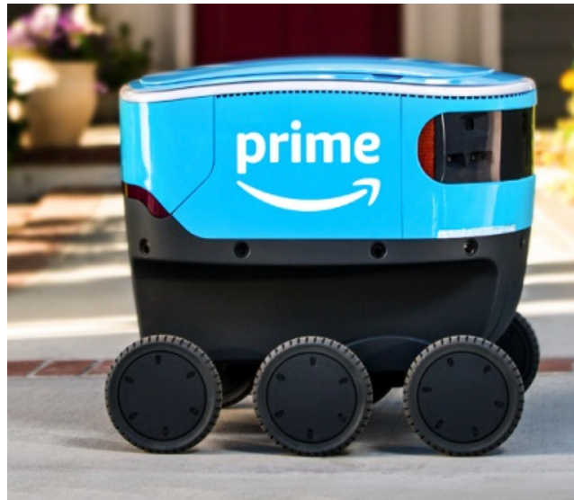
Рисунок 2.1 – НРЗ на базі колісного шасі «Scout» by Amazon [25]
