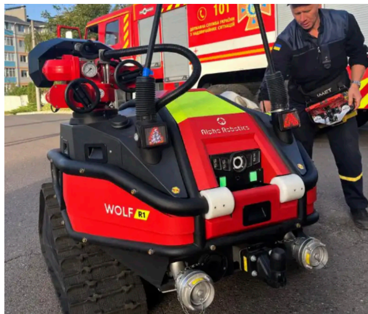
Рисунок 2.2 – НРЗ на базі гусеничного шасі Magirus «Wolf R1» [26]
