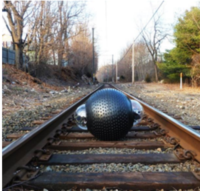
Рисунок 2.4 – НРЗ на базі сферичного шасі « GuardBot » by GuardBot Inc. [28]
