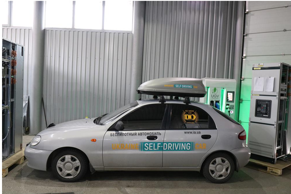
Рисунок 1.5 – Перший легковий український безпілотний автомобіль створений на базі ЗАЗ «Lanos»
